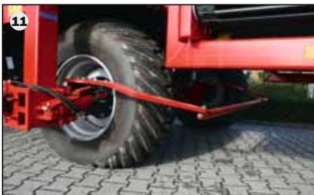
Увеличьте манёвренность: гидравлическое управление опорными колёсами обеспечивает уникальную маневренность компактного BR 150/170.
