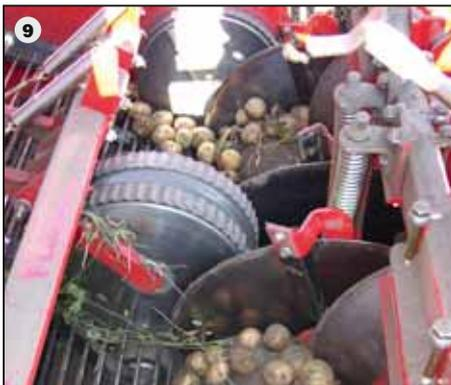
Продуманная концепция подкопа: посредством 2-х лопаточного лемеха производится одновременный подкоч 2-х гребней и подача на первый просеивающий транспортёр. Через совместную работу 4-х подпружиненных сошниковых дисков и 4-х ботвозагтягивающих роликов подкапывающее устройство работает без забиваний даже при самых тяжёлых условиях уборки.
