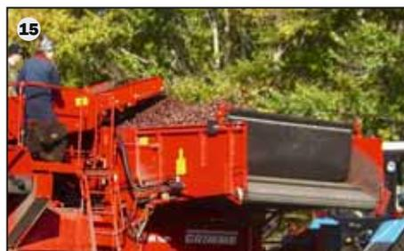
15 Высокопродуктивный: бункер с гидравлическим приводом донного транспортера и оптимизатором наполнения бункера ёмкостью в 4,5 тонн обеспечивает, благодаря лёгкому изгибу головной части, быструю и бережную перегрузку продукта.
