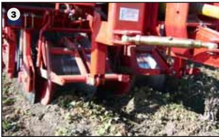
Превосходный обзор: механизатор из кабины трактора постоянно держит под контролем 2-х рядное подкапывающее устройство. Ширина междурядья: 75 см (серия), 90 см с дополнительным коротким приёмным транспортёром (опция).
