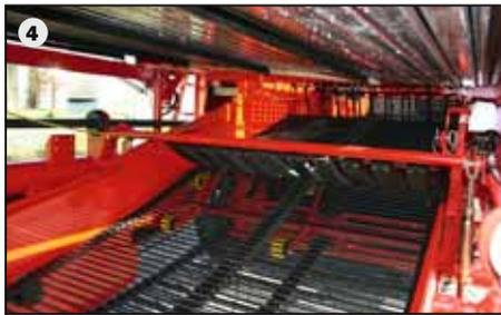
Что не протрясли – продавим: комкователь хорошо зарекомендовал себя особенно на комковатых почвах. Обрезиненный привод трёх просеивающих транспортёров надёжен и безотказен в работе.
