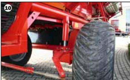
Держит уровень: гидравлическая система регулировки наклона позволяет при работе на склонах удерживать комбайн в горизонтальном положении – для обеспечения оптимальных условий работы комбайна.
