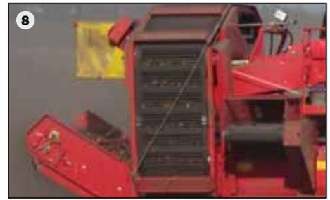
8 Он подаёт, подаёт, подаёт: чрезвычайно крепкий кольцевой элеватор обеспечивает бережный подъём и транспортировку продукта к инспекционному столу.
