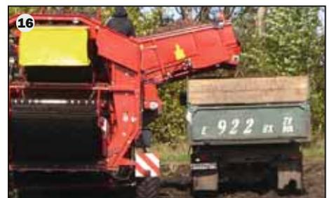
16 Всегда на высоте: с высотой перегрузки в 3,40 м можно оптимально загружать транспортные средства.
