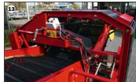
Регулируем бесступенчато: гидравлическая регулировка скорости инспекционного транспортёра осуществляется при помощи пульта управления.
