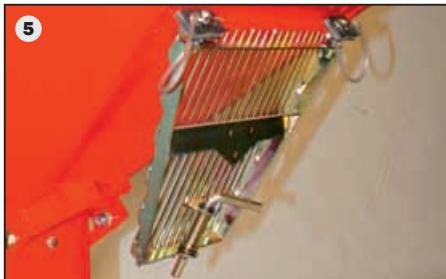
Необходим для пророщенного картофеля: вибрирующая вставка для пророщенного картофеля (4) обеспечивает равномерную подачу и поддержание низкого уровня семенного материала перед ложечной лентой.
