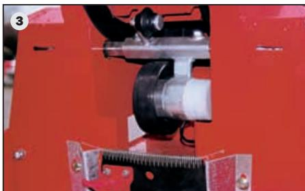
Лёгкое отключение: быстрое ручное отключение ряда с помощью фиксирующего рычага (1) (опция) или – опционального электрического отключения (2) высаживающего аппарата из кабины трактора.
